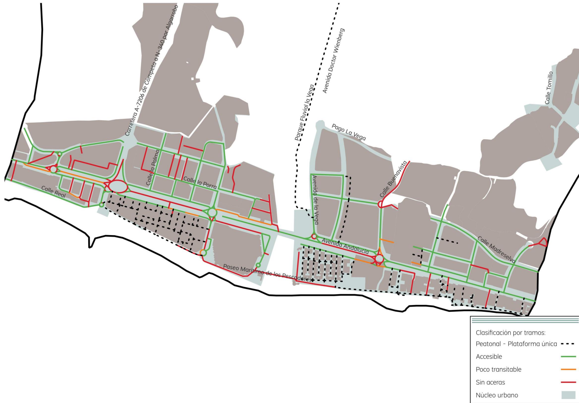
Figura 38. Tipología del acerado de Algarrobo Costa. Elaboración propia
